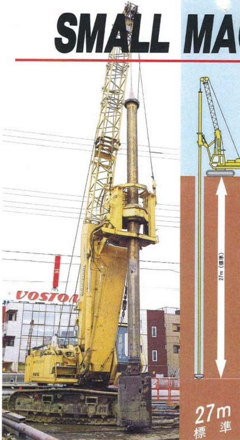
住友SD-105は現場ニーズを高度に反映した最新鋭小型アースドリルです。土木・一般・建築の基礎工事での場所打ち杭施工に威力を発揮します。住友はヨーロッパをはじめ世界各地で、基礎工事専用機械に実績と定評をもつ、イタリア・ソイルメック社とのタイアップにより、パワーと耐久性に優れた最新鋭のアースドリルを現場に提供しています。
